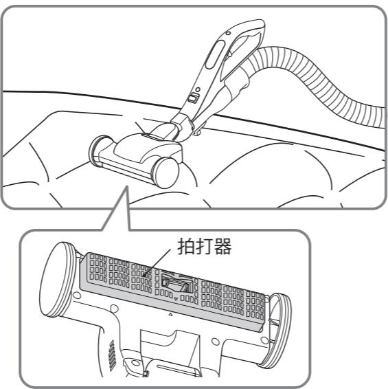
請將電動棉被拍打吸頭安裝於延長管或操作把手後再使用。
