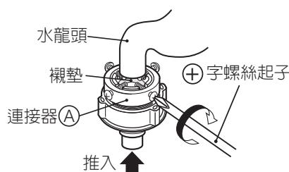
**5** 將連接器②朝箭頭方向旋轉，讓連接器①與②的間隙在4mm以下。
