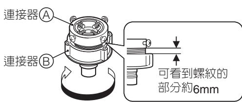
**3** 將連接器①的4個螺絲擰鬆到能插入水龍頭，然後將連接器①套在水龍頭上。
