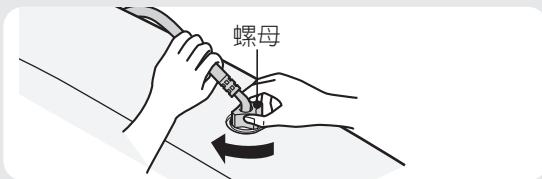
• 若未將螺母確實鎖緊，將導致漏水。
