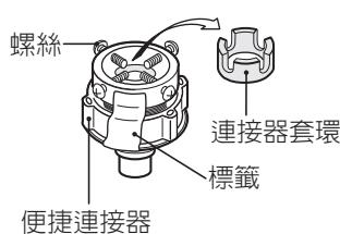
**2** 確認連接器套環①與②的間隙(約6mm)。
