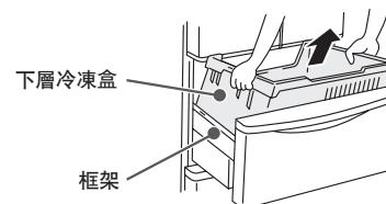
安裝冷凍盒時，請將下層冷凍盒左右突出的部分向門框兩旁的洞插入固定。
