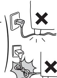
在已受損的狀態下使用時，會引發觸電・短路・火災的危險。
