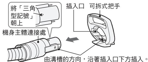
**2** 將軟管組裝口和軟管銜接處相連結，直到「卡奇」一聲才算完全接合。
